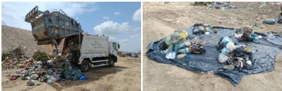
**Figura 2.** Realização do quarteamento para o ensaio de composição gravimétrica (2021).
