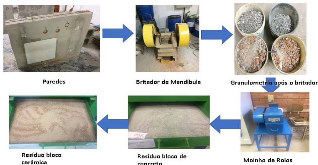
Figura 1. Processo de beneficiamento do RCD
