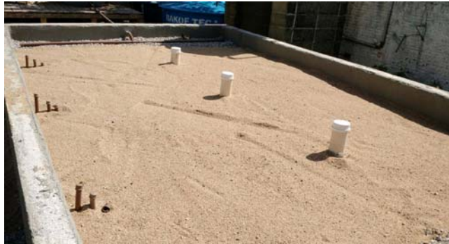
Figura 2. Pontos parciais de amostragem (tubulações centrais brancas) ao longo do comprimento do WCH.
