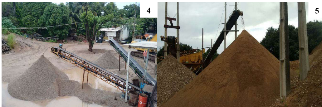
Figuras 4 e 5: Usifort e Reciclo Ambiental, respectivamente, usinas de reciclagem de RCD credenciadas pela SCSP. Fonte: Lima, T. B. R., 2017
