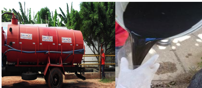
Figura 1. Ilustração de um caminhão limpa fossa descarregando na estação e a realização da coleta
