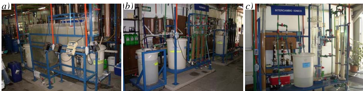
Figura 2. Simulación física de diferentes trenes de tratamiento de las aguas congénitas en planta piloto: (a) ablandamiento; (b) descarbonatación, oxidación química, filtración y adsorción; (c) intercambio iónico.
