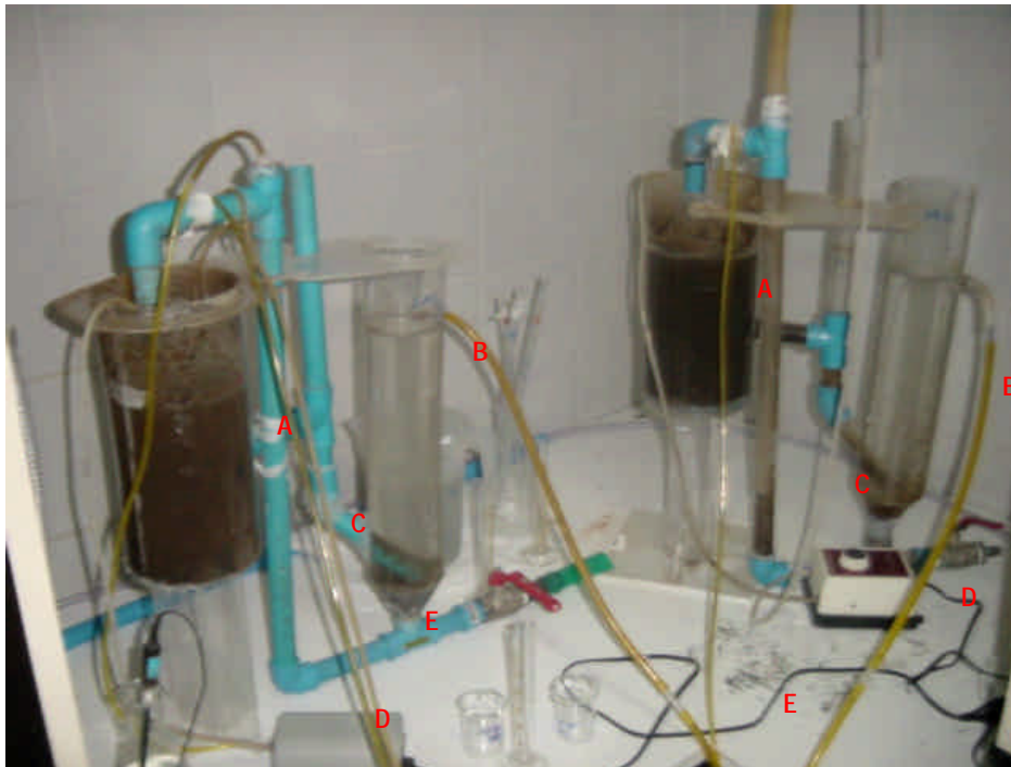
Fig. 1: Sistemas de lodos activados 1 y 2 escala de laboratorio. A: Tanque de oxidación, B: Sedimentador, C: Recirculación, D: Bomba de aire, E: Alimentación.
