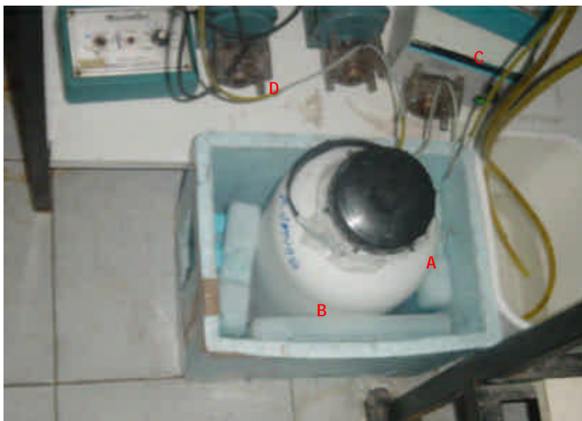
Fig.2: Sistema de alimentación con refrigerante. A: Estanque de alimentación, B: refrigerante, C: Bombas de alimentación, D: Bomba control de pH.
