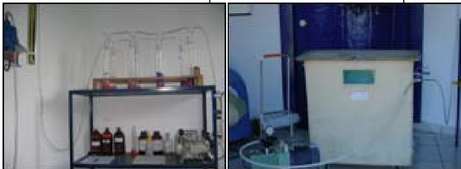
FIGURA 2: Sistema de amostragem das análises químicas e olfatométricas.
