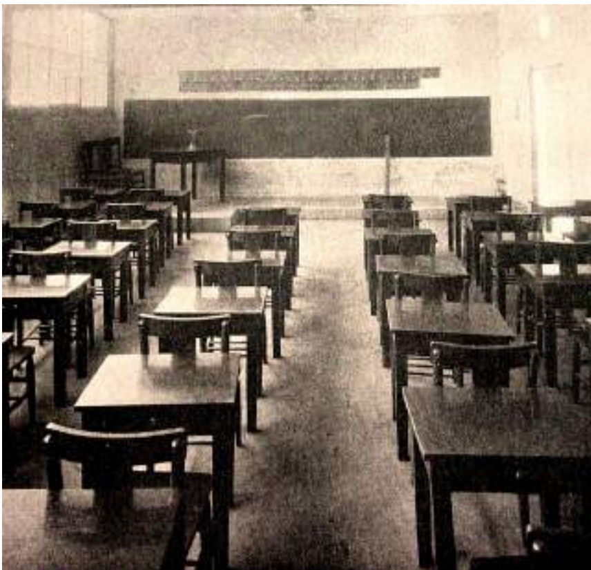
Figura 8. Puede observarse como la ventilación disminuye en el interior del aula al contar con ventanas en solo un costado de este. Escuelas 1932, SEP.
