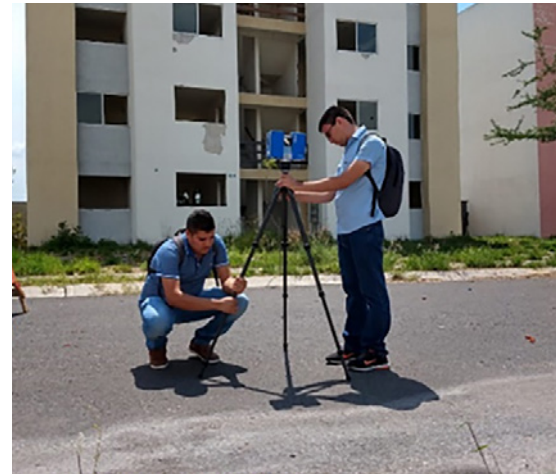
FARO scanner en funcionamiento. Fotografía: FCC, junio 2019.
