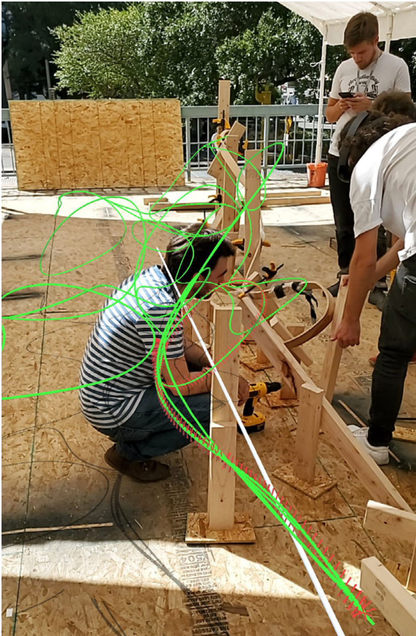
Taller de fabricación de forma libre: estructuras de madera que se doblan a mano con guías holográficas inteligentes a partir de Fologram y Hololens. Gwyllim Jahn y Cameron Newnham · Acadia · Universidad de Texas, Austin. Imagen: RBL, 2019.
