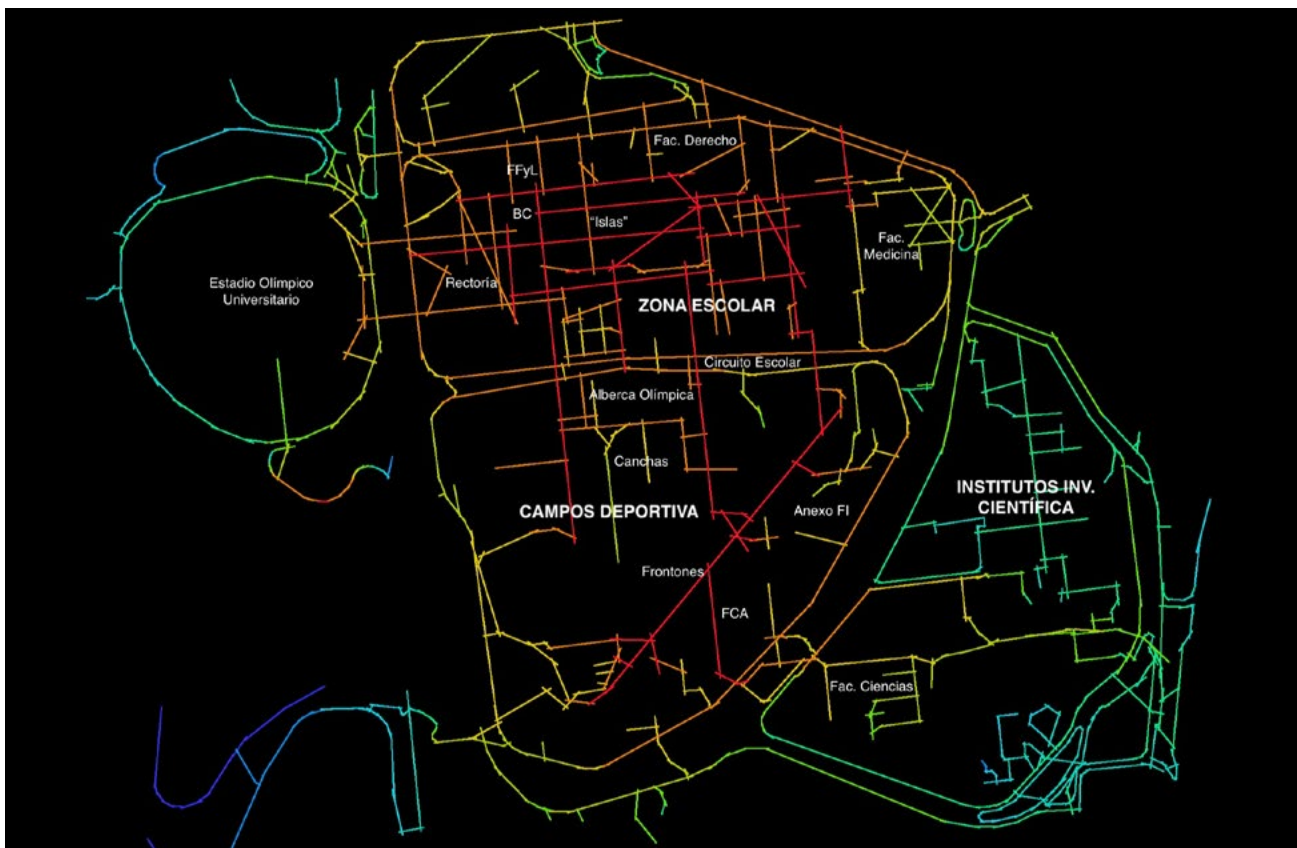
Integración o accesibilidad global de red de movilidad peatonal de mapa axial de cu. Elaboración de los autores con base en catastro de la alcaldía Coyoacán, analizado con DepthmapX.
