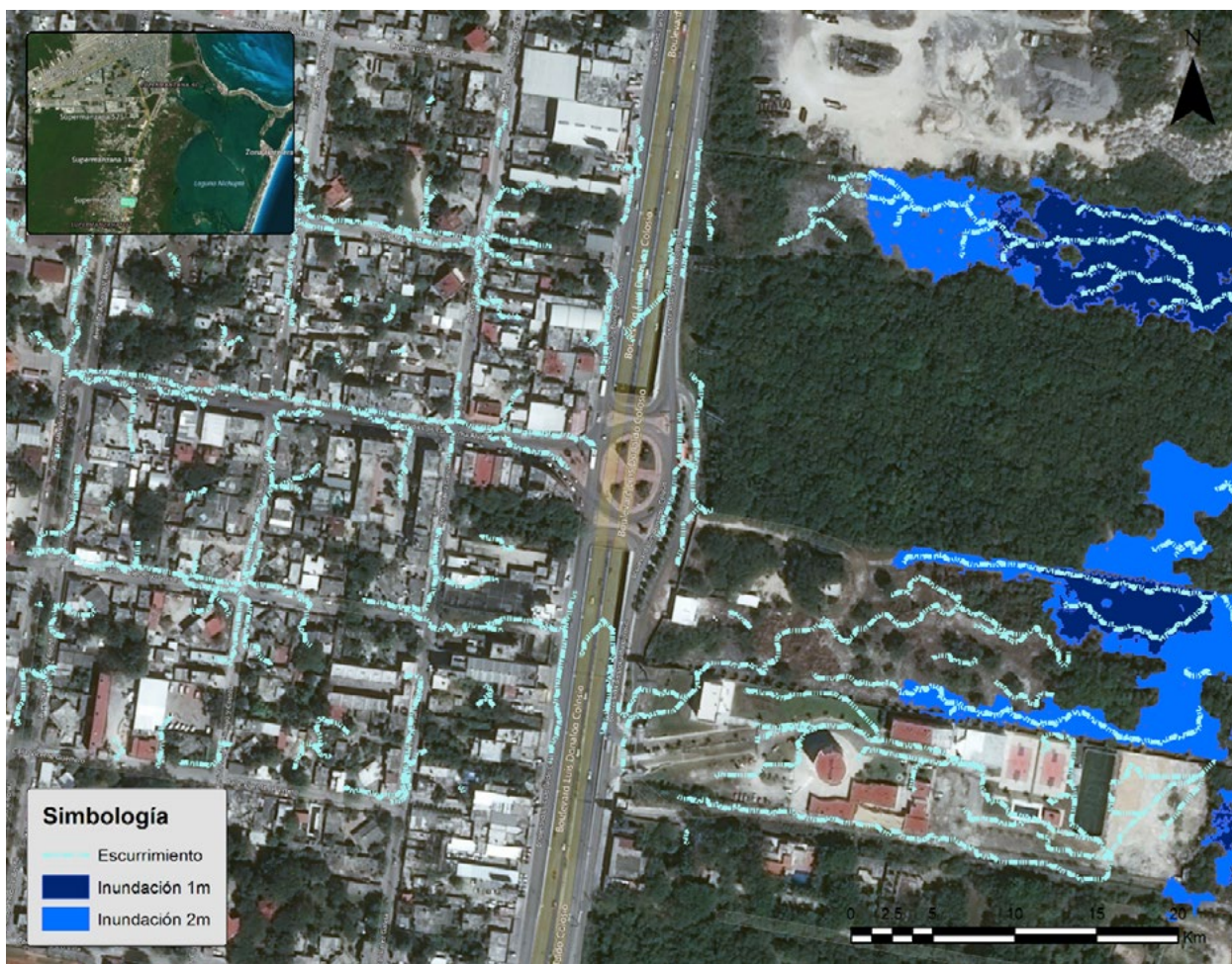
Imagen 5. Modelación hidrológica de un sector de la localidad de Alfredo V. Bonfil, 2018
