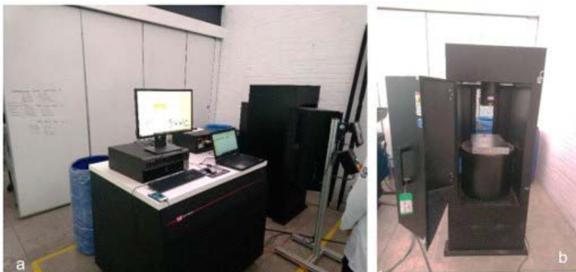
Equipo para los ensayos a compresión: Instron modelo 400RD-E1-H2, capacidad 80 Ton., equipo con el software incorporado y una cabina. Fuente: Elaboración propia, 2019
