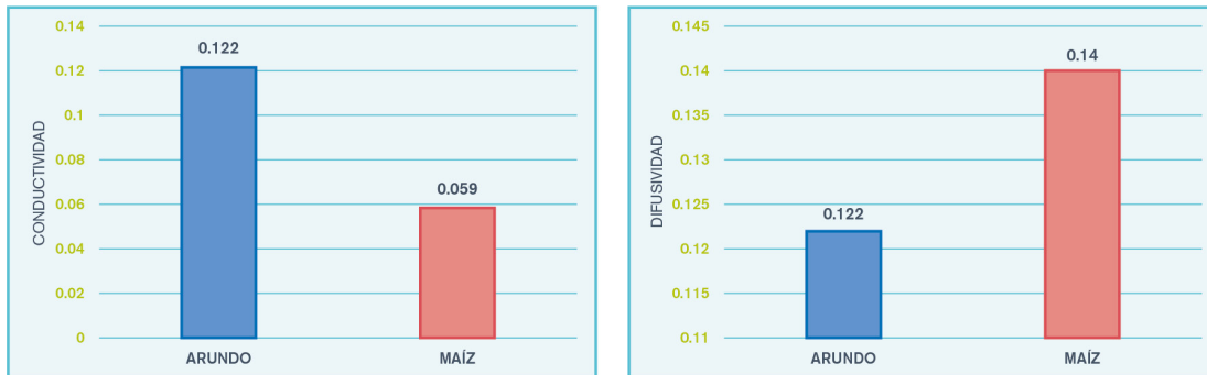
Gráfica 3: Comparación desempeño conductividad-difusividad. Clasifican por su baja conductividad de materiales aislantes. Una menor difusividad reduce transferencia de calor. Por lo tanto, el Arundo Donax tiene mejor desempeño.
