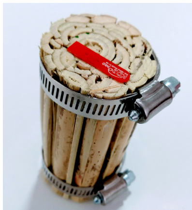
Probeta de Arundo según ASTM 5334-08. Imagen del autor
