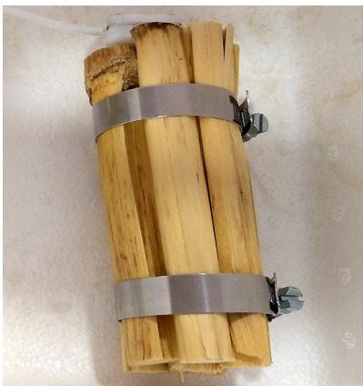
Probeta Zea M según ASTM5334-08 en cámara de aislamiento. Imagen del autor
